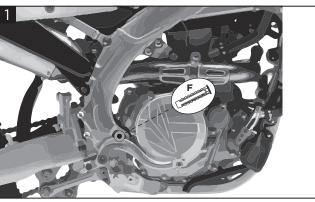
Introduce the expander (F) in the hole of the frame. Inserire l'expander (F) in plastica nel foro del telaio.
